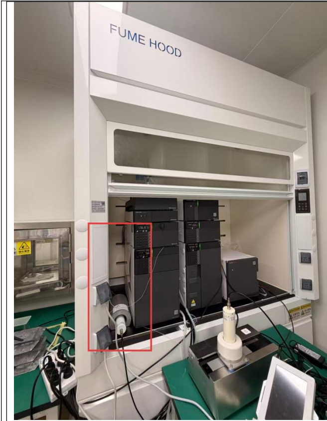
通风橱内涉放实验设备局部铅屏蔽
